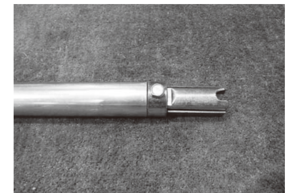
写真2 ボンジョイントを使用して、片側のみに単管を接続した状態。
